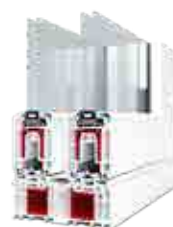
Marco inferior de pvc: 175mm de ancho, con 8 cámaras de aislamiento.
